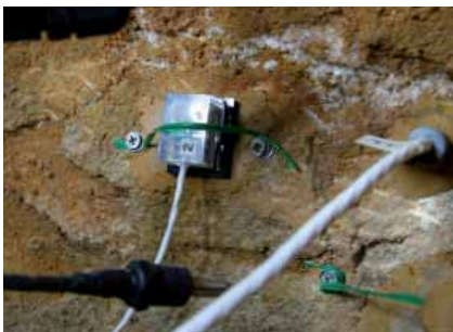
Fig. 2 Installazione del dew sensor alle grotte di Lascaux (Francia). Dew sensor at Lascaux caves.
