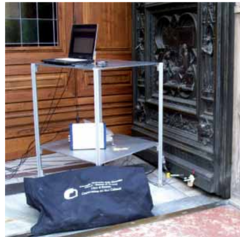
Fig. 2 Misura EIS in situ . Test protettivi sulla Porta del Duomo di Firenze (progetto europeo EU-ARTECH).
