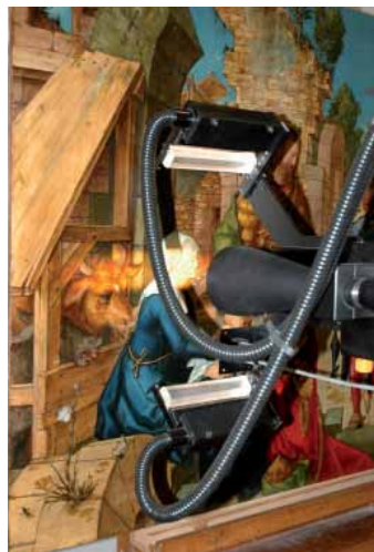
Fig. 2 Acquisizione immagini iperspettrali su dipinto con scanner ad altissima risoluzione spaziale e spettrale sviluppato presso IFAC-CNR.
