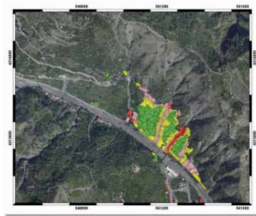
Fig. 2 Zonazione del rischio da frana e da colata di detrito per l'abitato di Giampilieri, Sicilia.
