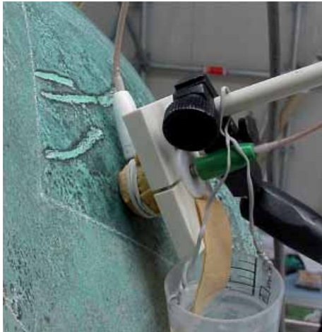
Fig. 1 Contact-Probe. Misure in situ nel corso del restauro del Monumento a Bartolomeo Colleoni del Verrocchio (Venezia).
