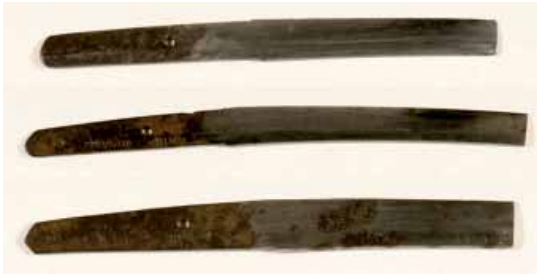
Fig.1 Immagine di tre spade antiche in acciaio (epoca Koto, prima del 1600 A.D.) analizzate attraverso la diffrazione neutronica. Le figure di diffrazione corrispondenti sono riportate nella Fig. 2.
