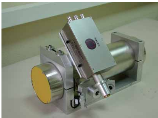
Fig. 1 Lo spettrometro XRF portatile sviluppato dall'ITABC. The portable XRF spectrometer developed at ITABC.
