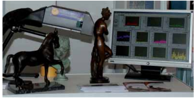
Fig. 2 Utilizzo dello strumento LIPS nell'autenticazione di bronzetti. Application of LIPS for authenticating copper alloy statuettes.
