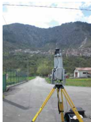
Fig. 2 Rilevamento laser scanner del centro abitato di Fossa (L'Aquila) nell'ambito delle attività di supporto svolte dal CNR in seguito al terremoto del 6 aprile 2009.
