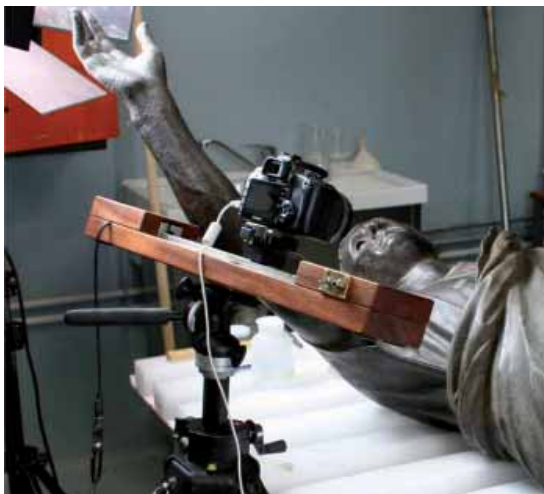
Fig. 1 Camera digitale montata sulla barra motorizzata di precisione durante la fase di acquisizione.
