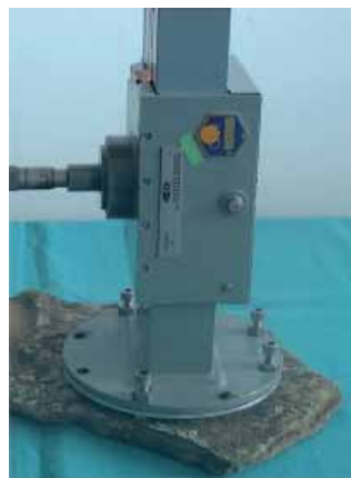
Fig. 2 Applicatore a microonde per il trattamento di licheni su materiale lapideo. Microwave applicator to control biodeteriogens agents (lichens, fungi, etc.).
