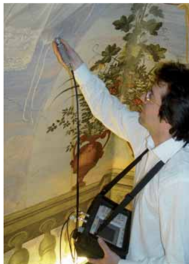
Fig. 2 Dielettrometria per la misura del contenuto di umidità e di elettroliti su dipinti murali (Loggia de' Allori, Palazzo Pitti, Firenze).
