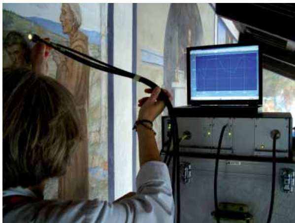
Fig. 1 Procedura per avvicinamento della sonda alla zona del dipinto murale da misurare mediante tecnica FORS in situ .
