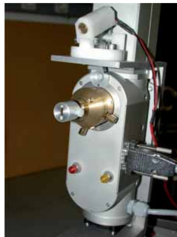
Fig. 2 La sorgente microfoco con ottica policapillare installata nel diffrattometro. The microfocus X-ray source coupled to the polycapillary optics installed on the diffractometer.
