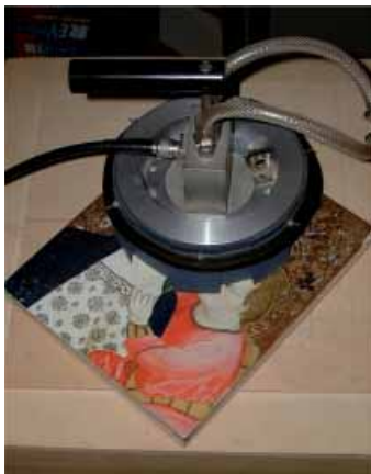
Fig. 1 Applicatore a microonde per il trattamento di insetti xilofagi su tavole dipinte. Microwave applicator for wood paintings treatment.
