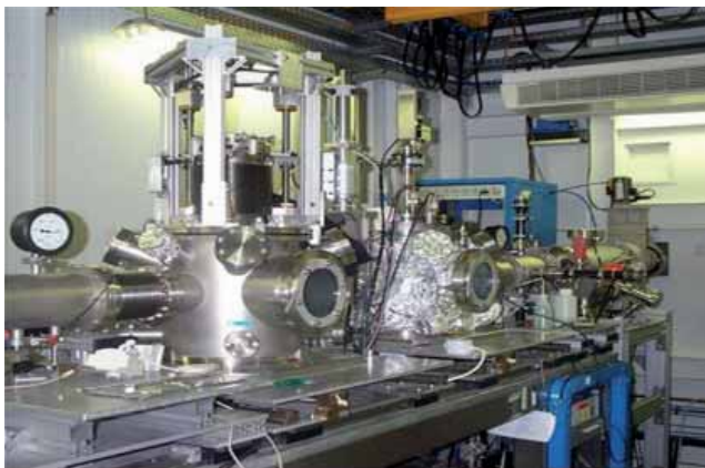
Fig. 1 Lo spettrometro per analisi di assorbimento di raggi X. Presso GILDA si possono effettuare studi su elementi in traccia fino al limite di alcune ppm.
