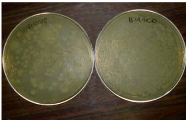
Fig.1 Piastre per la conta delle colonie di E. coli : crescita inibita per piastra da test su nanocomposito (campione) rispetto a bianco di riferimento.
