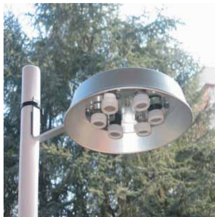
Fig. 2 Sostegno per l'esposizione del campionatore Analyst® all'aperto. The Analyst sampler exposed outdoors.
