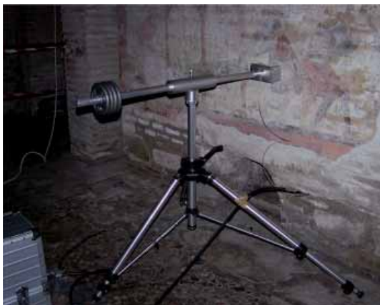
Fig. 1 Misurazione con NMR portatile dell'umidità in un affresco antico (La messa di S. Clemente e la leggenda di Sisinnio, Basilica di S. Clemente Roma).
