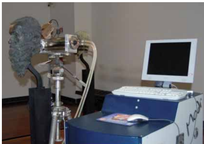
Fig. 2 Analisi LIPS del 'Filosofo di Porticello' presso il Museo Nazionale Archeologico di Reggio Calabria.
