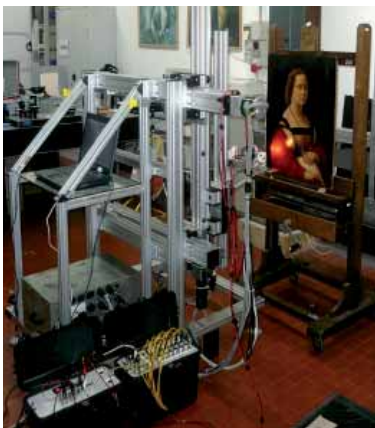
Fig. 1 Indagine con lo Scanner Multi-NIR realizzato dall'INO-CNR su "La Gravida" di Raffaello, in restauro presso l'Opificio delle Pietre Dure di Firenze.
