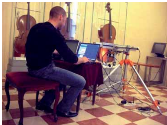
Fig. 1 Rilievo delle ampiezze anulari con il dendrocronografo portatile direttamente nella teca di conservazione.
