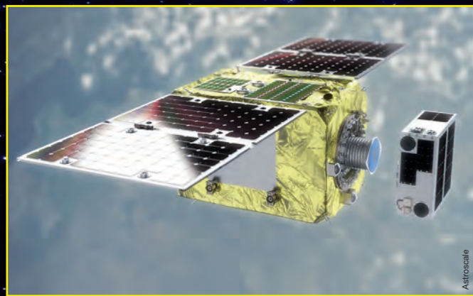
2 Elsa (End-of-Life Services Astroscale): missione della società spaziale giapponese Astroscale. Prevede un satellite dotato di un magnete per agganciare detriti. Un prototipo è stato lanciato a marzo 2021.
