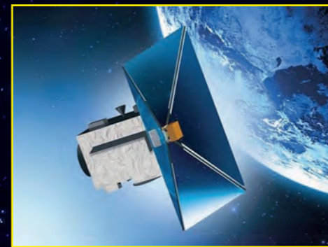
5 Adeo (Drag Augmentation Deorbiting Subsystem): sistema di vele da 3 a 100 m 2 che spinge il satellite in disuso in un'orbita più bassa per farlo disintegrare. È applicabile ai nuovi satelliti fino a 1,5 tonnellate di massa. Progetto Esa.
