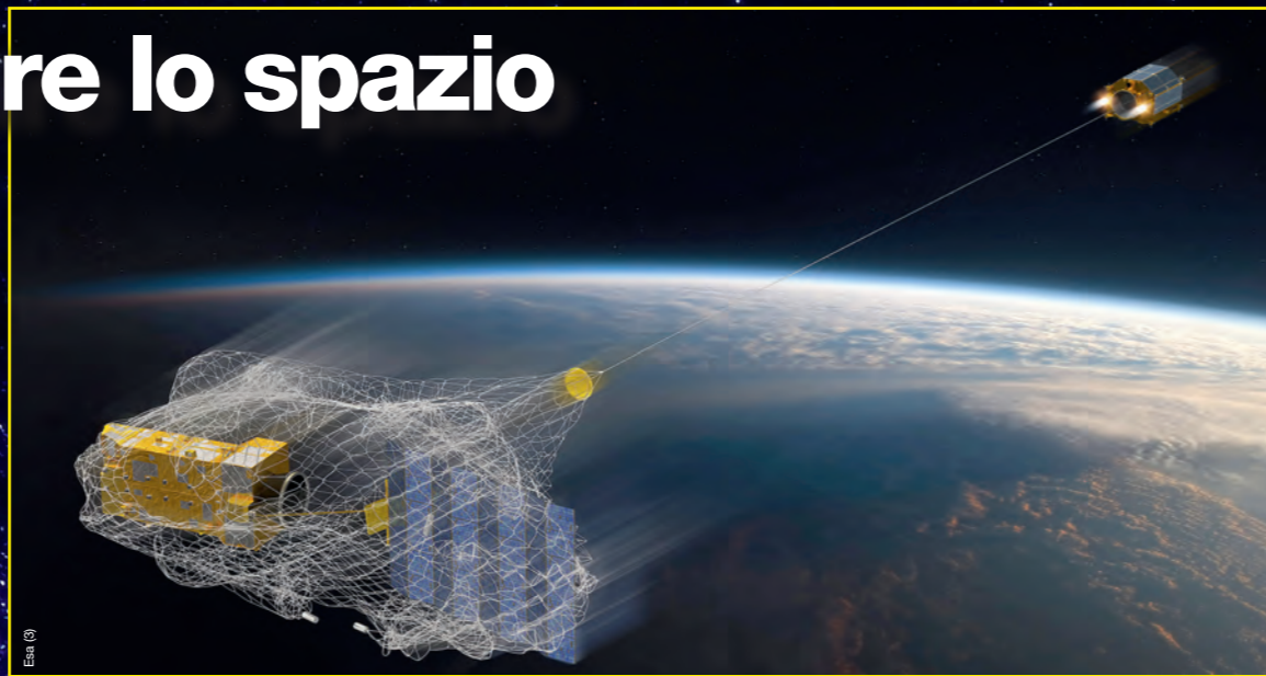
3 RemoveDebris: rimozione dei detriti spaziali catturandoli con una rete o con un arpione. Svolti con successo test in orbita nel 2018 e 2019. Progetto dell'Università del Surrey con un consorzio di imprese.
