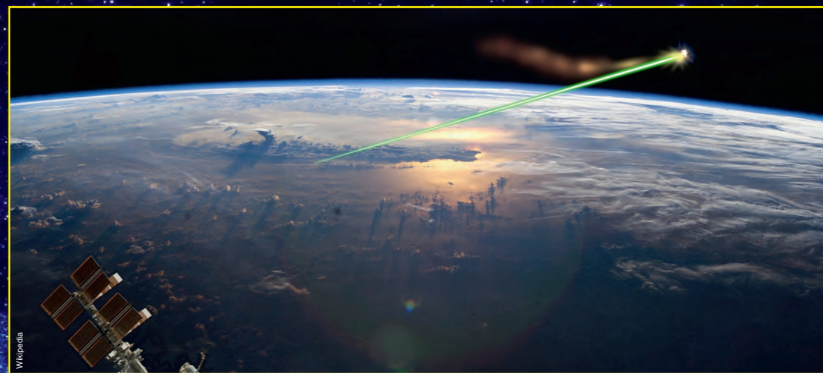
7 Indirizzare fasci di laser a infrarossi per deviare l'orbita di piccoli detriti (1-10 cm di dimensioni), evitando collisioni con oggetti più grandi. Riscalda un lato dell'oggetto così da cambiare la sua orbita e farlo cadere prima in atmosfera. Allo studio in Esa.
